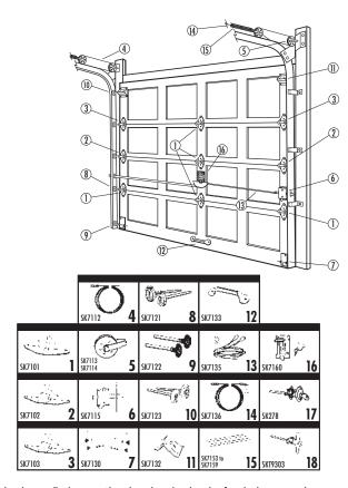
3. Enlever la vieille charnière, insérer la roulette dans la nouvelle charnière. Placer la roulette dans le rail et fixer la charnière sur la porte à l'aide des boulons; si la vieille charnière était vissée à l'aide de vis à bois ou de boulons, il est préférable de fixer la nouvelle charnière à l'aide de boulons et écrous. Percer des trous de 1/4" puis fixer la charnière à la porte.
